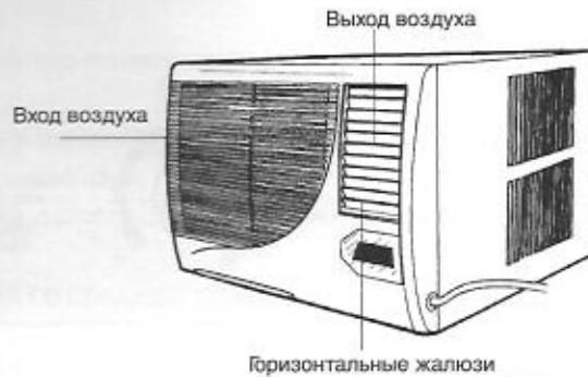
Установка и устройство оконного кондиционера
